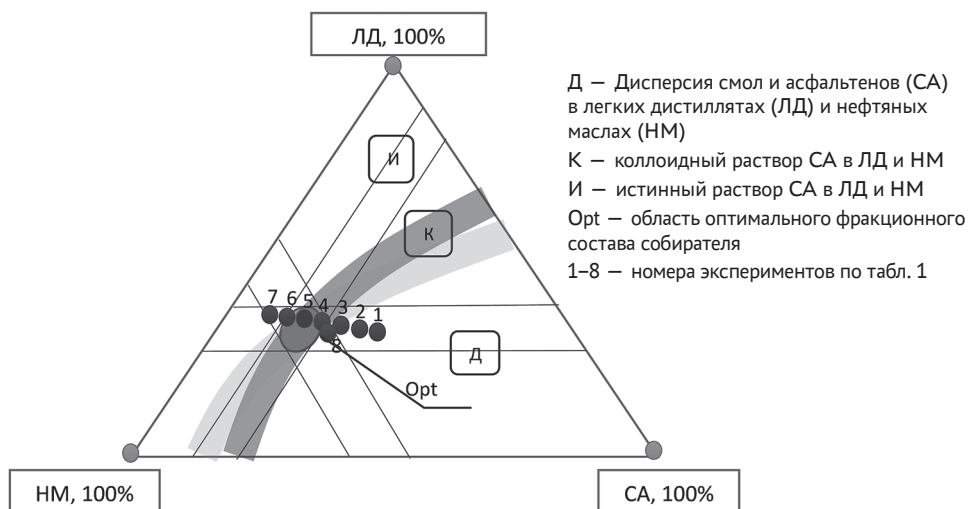
Рис. 3. Диаграмма трехфракционного состава компаундного собирателя
