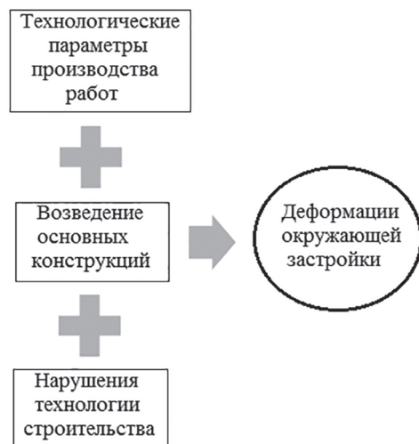
Рис. 2. Взаимосвязь основных параметров строительства и реакций окружающих зданий и сооружений
