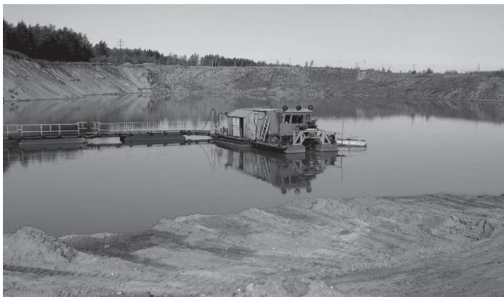
Рис. 3. Гидроэлеваторный земснаряд УГБ-2М на карьере ТКСМ
