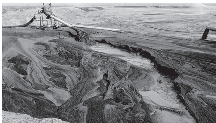
Рис. 1. Намыв шламов в хвостохранилище (Хазмина Т. Угольный шлам: вторая жизнь [Электронный ресурс]. URL: https://www.vnedra.ru/tehnologii/ugolnyj-shlam-vtoraya-zhizn-13710/ (дата обращения: 22.03.2022))
