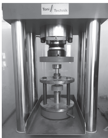
Рис. 2. Размещение образца между сферическими инденторами испытательной машины ToniNORM Fig. 2. Sample between spherical indenters of testing machine ToniNORM
