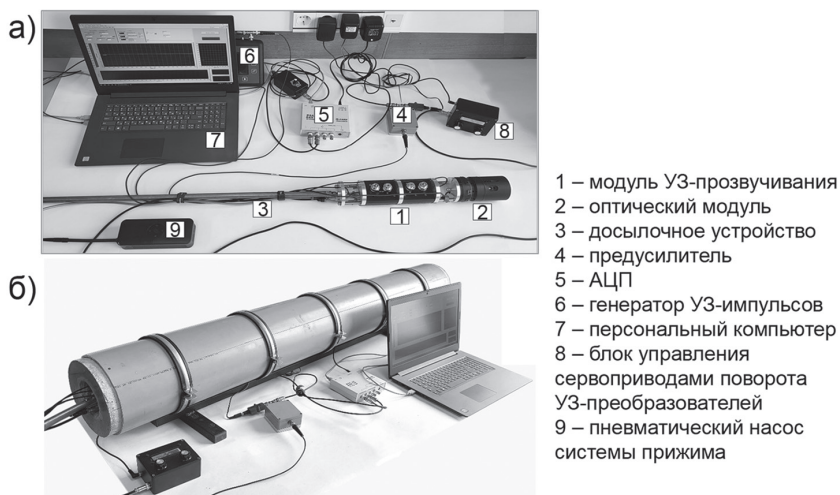
Рис. 2. Общий вид оптико-акустического каротажного комплекса (а) и физическая модель скважины (б) Fig. 2. Overview of optical-acoustic logging complex (a) and measurement process on well physical model (b)
