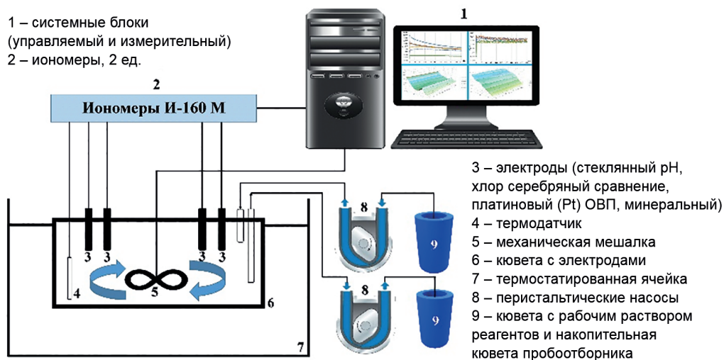
Рис. 2. Автоматизированная установка с термостатированной ячейкой для потенциметрических измерений
