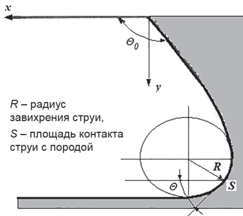
Рис. 1. Схема резания породы по глубине при гидростбойке Fig. 1. Diagram of rock cutting in depth during hydraulic punching
