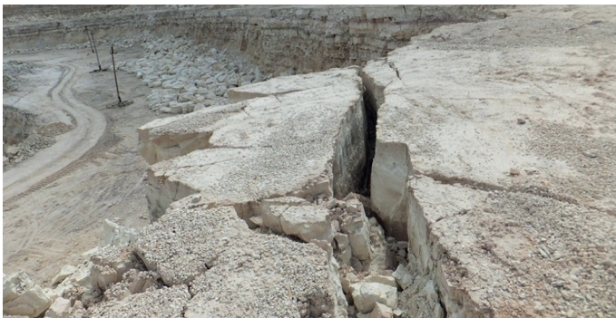
Рис. 12. Трещины (заколы, возникающие в зоне верхней бровки уступа при производстве взрывных работ)
