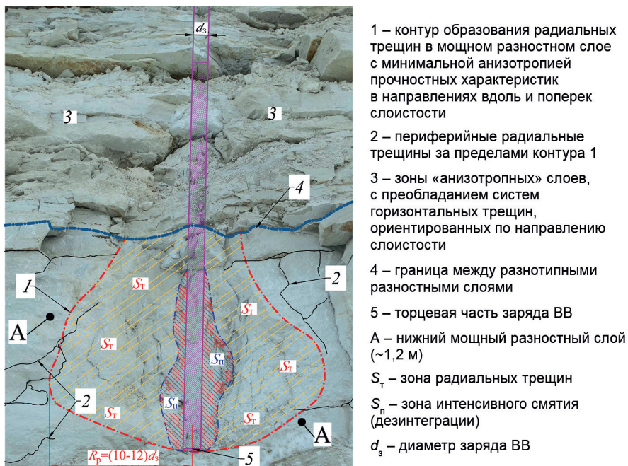
Рис. 5. Качественно-количественная картина разрушения мощного разностного слоя известняка, расположенного в почвенной зоне взрываемого уступа (взрывание без перебура) Fig. 5. Qualitative and quantitative picture of fracture of a powerful difference layer of limestone located in the soil zone of the blasted ledge (blasting without overdrilling)
