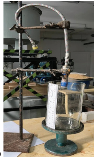
Рис. 1. Общий вид (а) и фотография (б) установки для изучения турбулизации воды струями воды и сжатого воздуха
