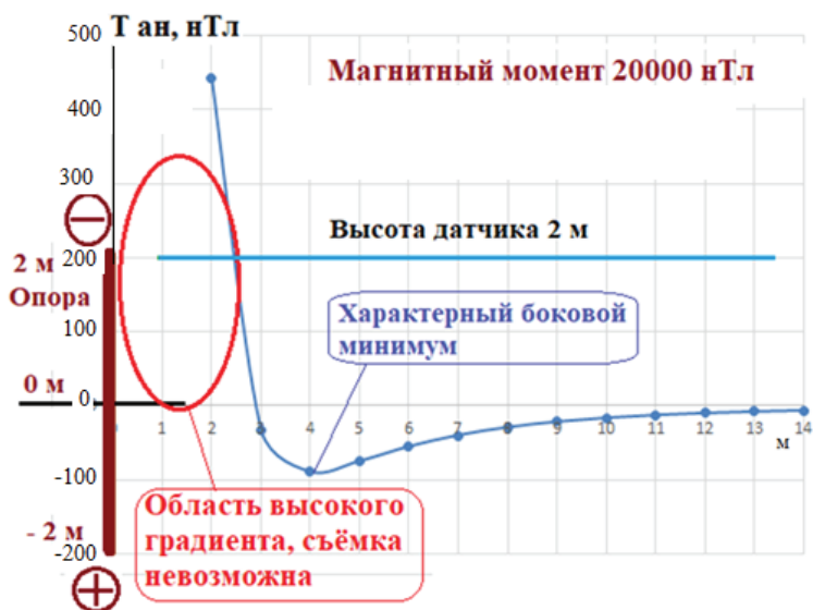
Рис. 1. График вертикальной составляющей аномального поля от вертикально намагниченного диполя (металлическая заземленная опора)
