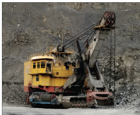
Рис. 1. Общий вид экскаватора ЭКГ-20 в забое
