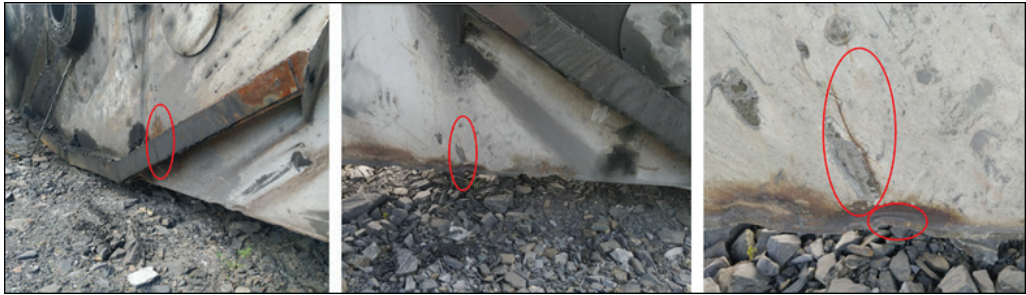
Рис. 6. Рост трещин на стреле экскаватора ЭКГ-20 Fig. 6. Growth of cracks on the boom of the excavator EKG-20
