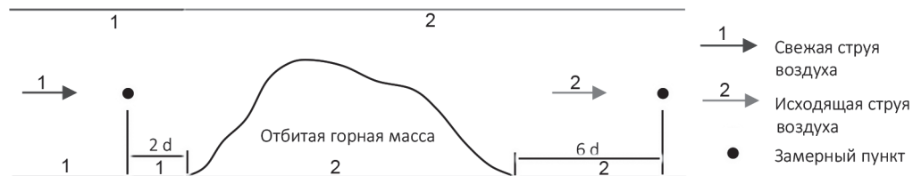
Рис. 4. Схематическое расположение замерных пунктов в сквозной выработке при измерении газовыделений от отбитой горной массы
