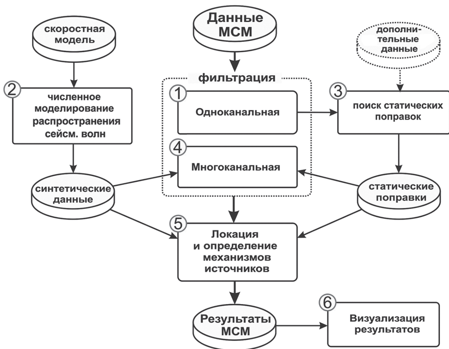
Рис. 1. Блок-схема программного комплекса обработки данных микросейсмического мониторинга Fig. 1. Microseismic data processing software
