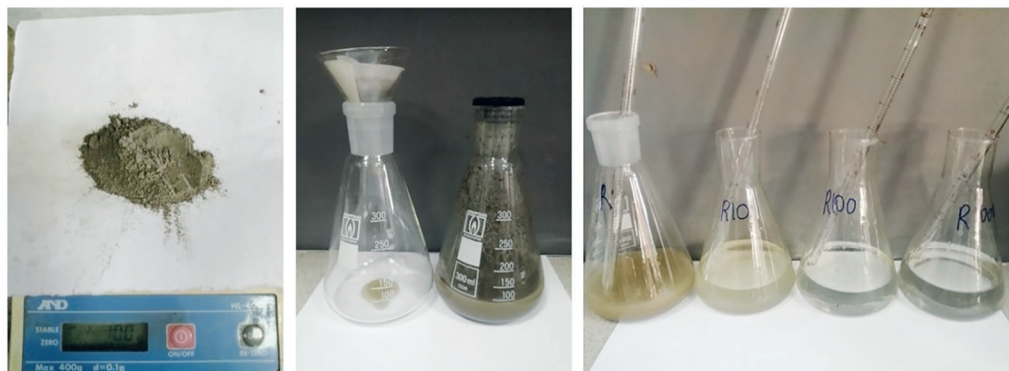
Рис. 1. Пробоподготовка водных экстрактов исследуемых песков для проведения фитотестирования Fig. 1. Sample preparation of investigated sands aqueous extracts for phytotesting
