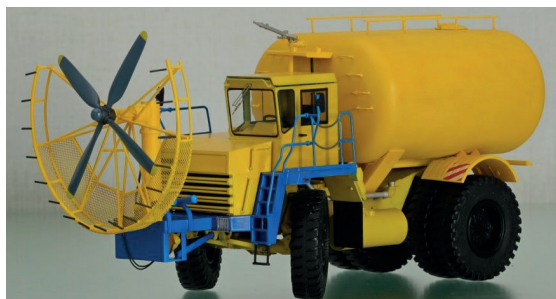
Рис. 3. Установка местного проветривания
