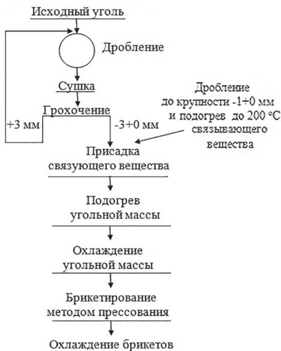
Принципиальная схема брикетирования бурого тонкозернистого угля Татауровского месторождения
