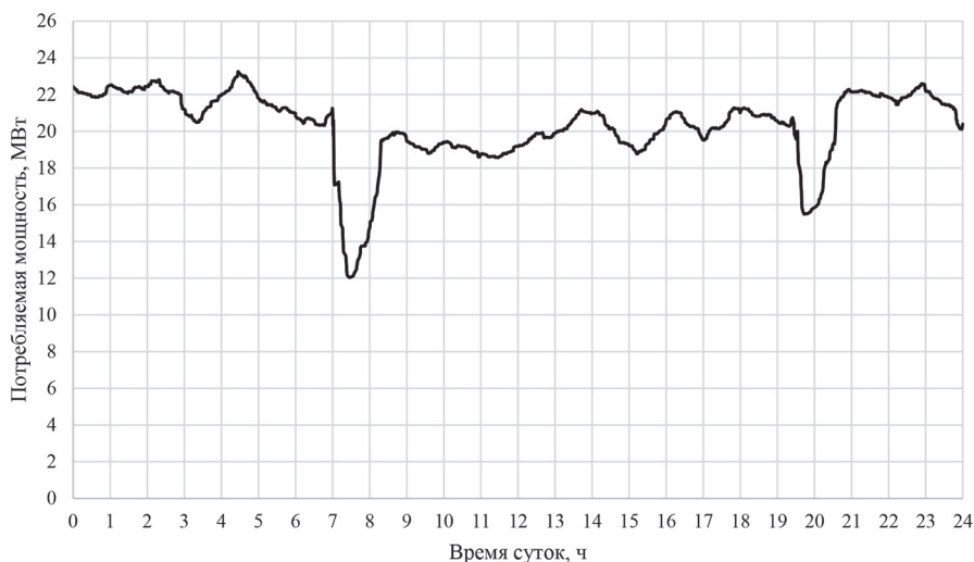
Рис. 2. Сглаженный график мгновенной потребляемой мощности Fig. 2. Smoothed graph of instantaneous power consumption
