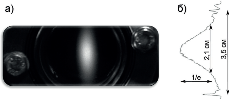
Рис. 4. Способ получения данных о геометрической расходимости атомного пучка в зоне подсвета: изображение подсвеченных атомов стронция, полученное при помощи видеокамеры через вакуумное окно во фланце DN40CF (а); распределение интенсивности подсветки атомов резонансным излучением (б)
