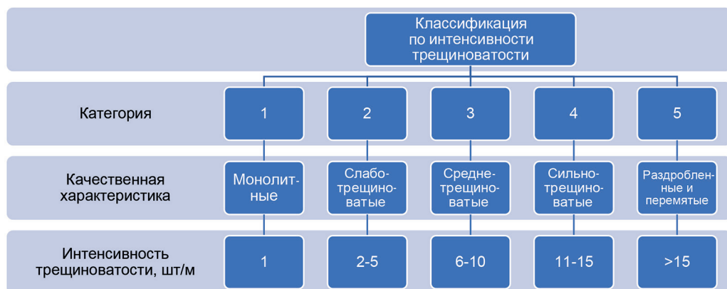
Рис. 2. Классификация пород и руд апатит-нефелиновых месторождений по интенсивности трещиноватости [составлено авторами]
