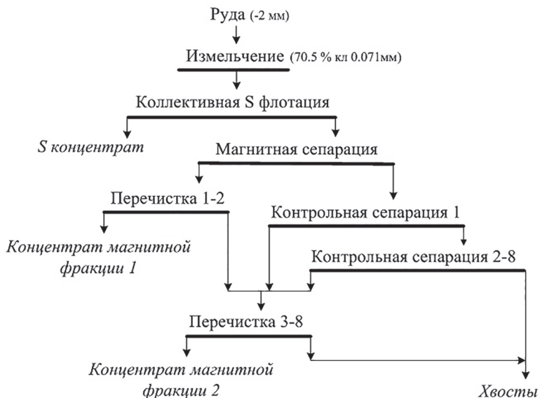
Рис. 2. Схема эксперимента по флотационно-магнитному обогащению золото-медно-порфировой руды Fig. 2. Simplified experimental flowsheet showing flotation and magnetic separation of Porphyry Copper-Gold ore
