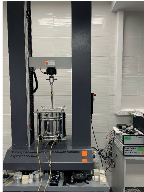
Рис. 6. Вид установки с установленным теплоизолирующим кожухом во время испытаний с термическим воздействием
