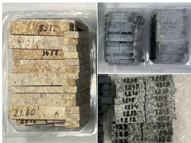
Рис. 3. Подготовленные в соответствии с ГОСТ 25.506.85 образцы
