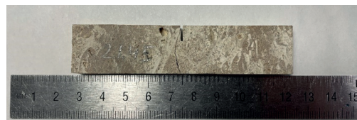
Рис. 7. Образец известняка после испытания на трехточечный изгиб с недопустимым отклонением плоскости разрушения
