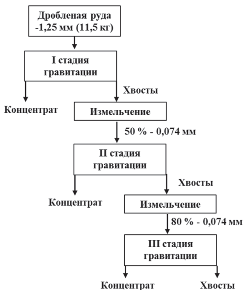
Рис. 4. Схема проведения GRG-теста
