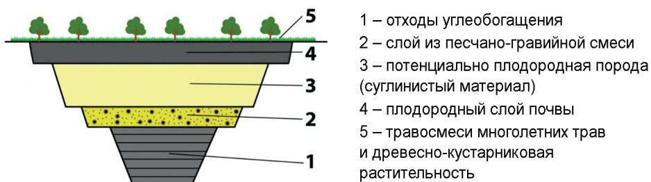
Рис. 8. Способ рекультивации с использованием отходов углеобогащения (при агрессивной реакции почвенного раствора, pH более 9–10)
