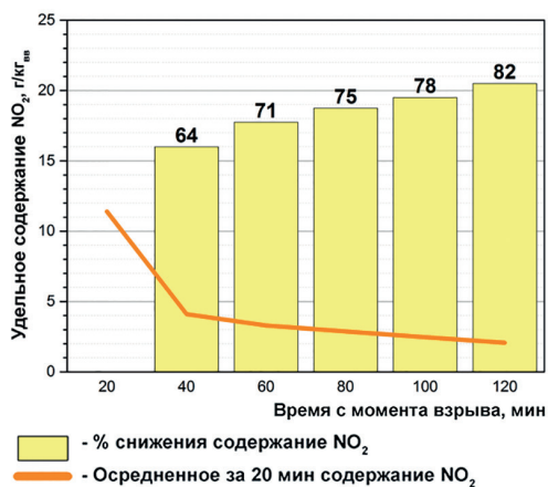
Рис. 8. Изменение во времени содержания токсичных газов после взрыва Аммонита № 6 ЖВ
