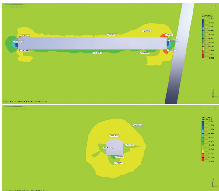
Рис. 10. Результаты численного моделирования с определением горизонтальных напряжений в массиве. S_{-YY} — горизонтальные напряжения по оси Y (по простиранию выработки) при диапазоне напряжений -5,852 \div -87,990 МПа
