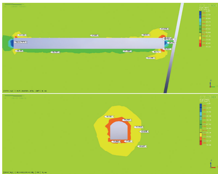
Рис. 5. Результаты численного моделирования в программе Midas с определением горизонтальных напряжений в массиве на завершающей расчетной стадии: S-YY — горизонтальные напряжения по оси Y (по простиранию выработки) при диапазоне напряжений -4,257 \div -91,226 МПа
