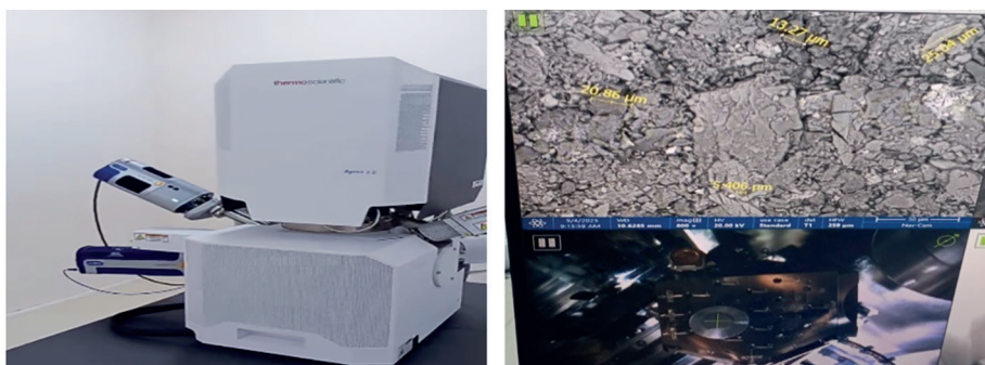
Рис. 4. Эксперимент по определению размера частиц пыли на приборе Thermoscientific Fig. 4. Experiment on determining the size of dust particles on the Thermoscientific device
