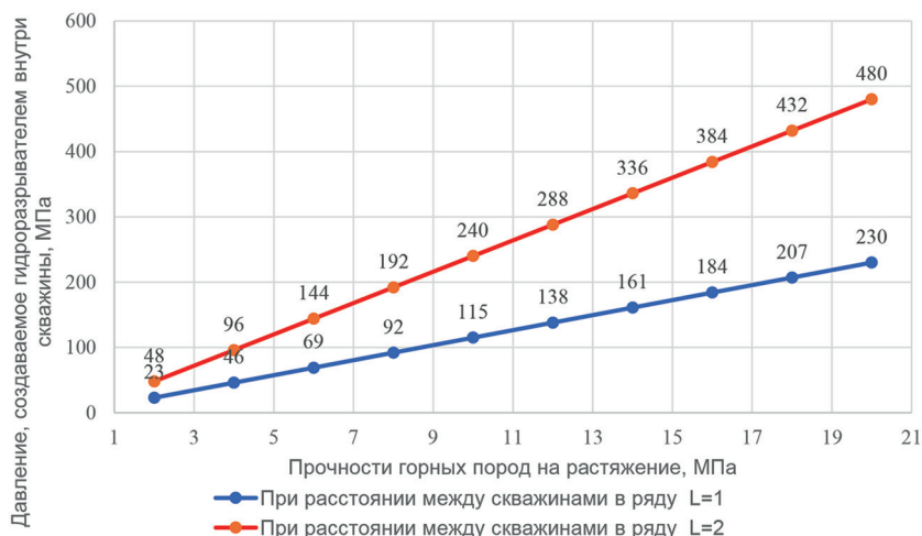
Рис. 12. Давление в скважине в зависимости от прочности пород на растяжение
