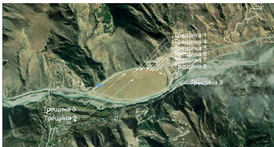
Рис. 2. Схема распределения трещин поверхности Унальского хвостохранилища (май 2026 г.) (наложенная на космический снимок)
