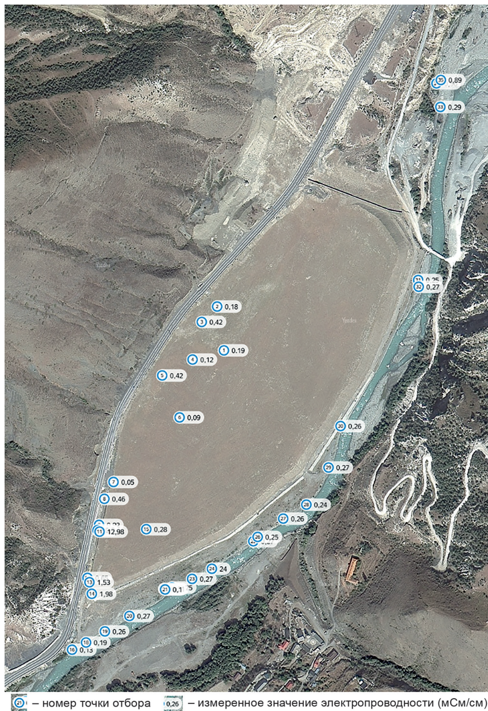
Рис. 3. Схема данных замеров электропроводности почвогрунта Унальского хвостохранилища и воды в реке Ардон (май 2026 г.), наложенная на космический снимок
