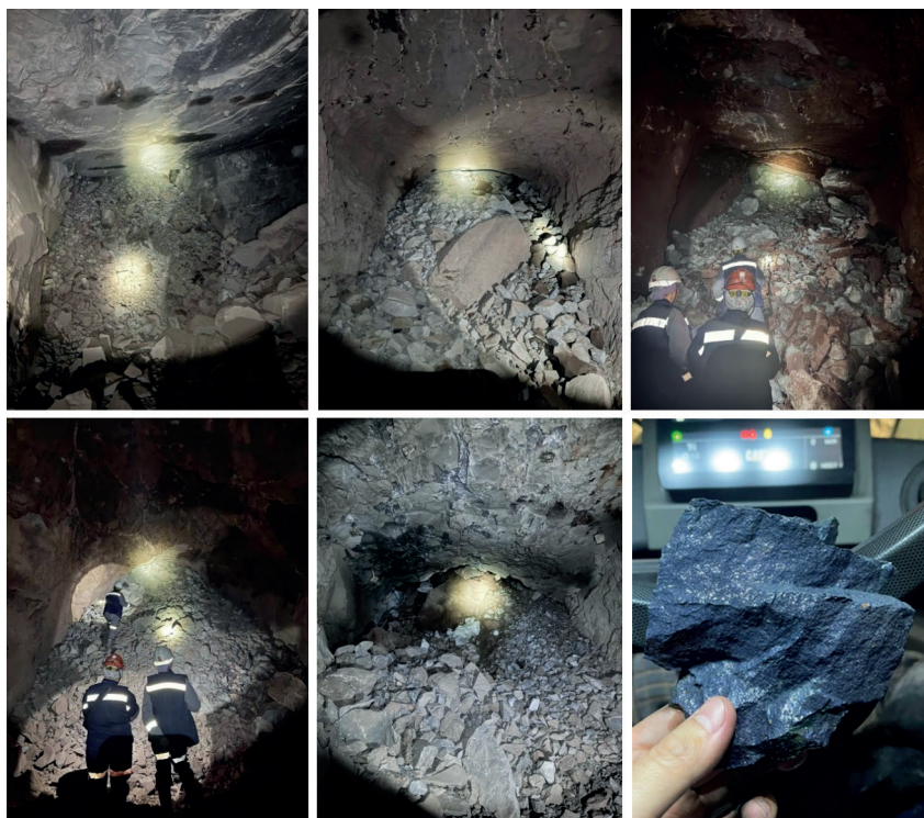
Рис. 2. Фотоснимки навалов рудной массы в очистных забоях Жезказганского подземного рудника Fig. 2. Photographs of ore piles in the cleaning faces of the Zhezkazgan underground mine
