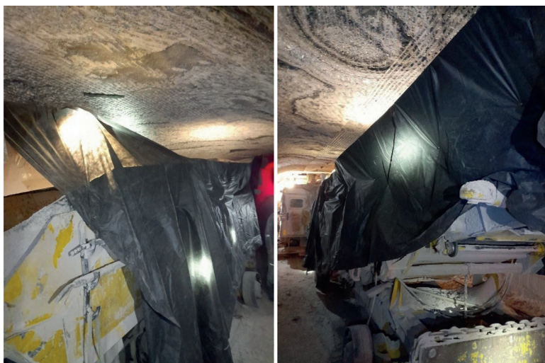
Рис. 3. Прототип съемного тента на бункере-перегрузателе Fig. 3. The prototype of removable tent for conveyer hopper
