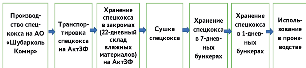
Рис. 5. Технологическая схема производства и использования спецкокса
