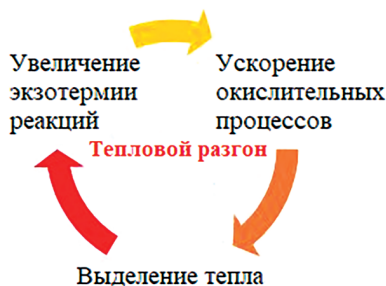
Рис. 1 Схема самонагрева и ускорения окислительных процессов
